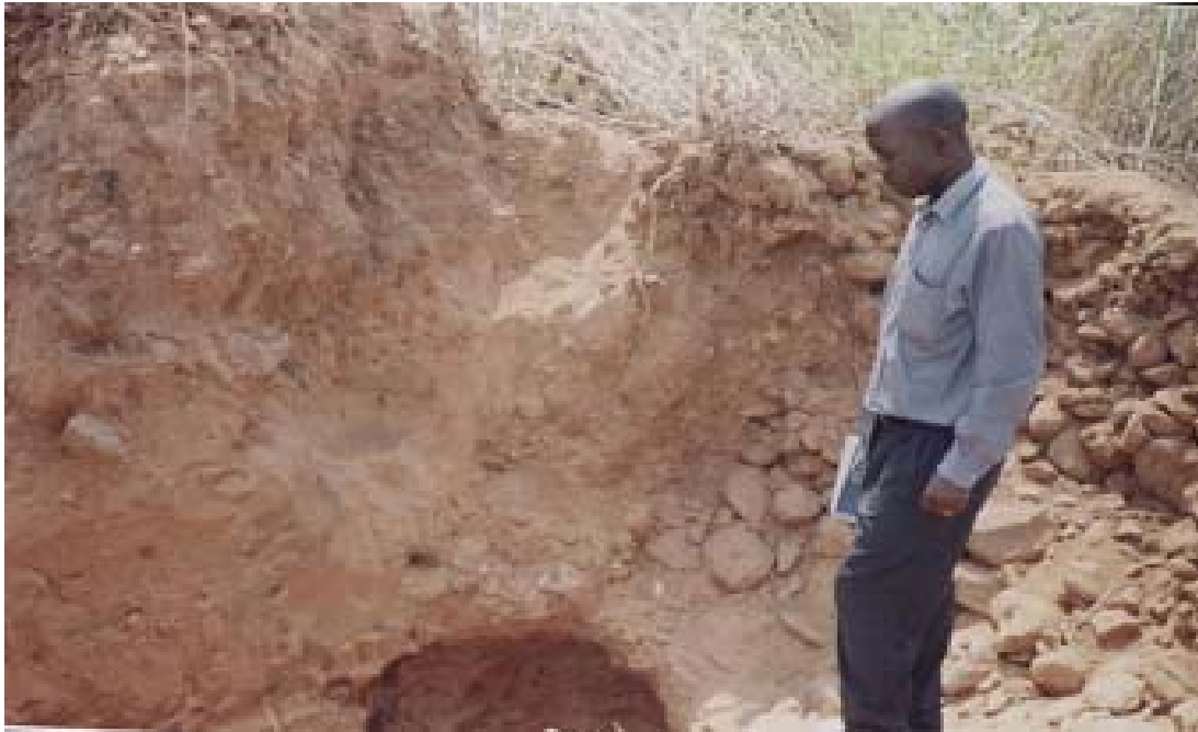
Galerie souterraine à la mine Bas –Congo pouvant atteindre 30 mètres de profondeur.
